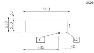
Electrical inlet (power) **Equipotential screw**
